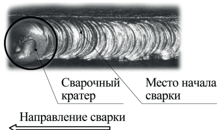
Рис. 7.4. Начало сварки при смене электрода.
